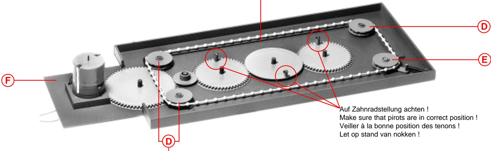
Beide Zahnräder so justieren, daß die Transportkette weder spannt noch durchhängt (Kugeln müssen in den Vertiefungen sein) !
