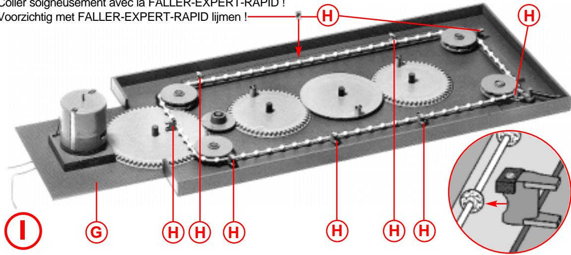
Die kleinen Magnete so in Teil 3/1 kleben, daß der markierte Punkt sichtbar ist. Die Magnete müssen unbedingt plan eigeklebt werden !
