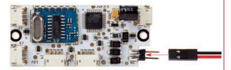
Verbinden Sie den Stecker für die Stromversorgung (2-polig) mit der Hauptplatine.
